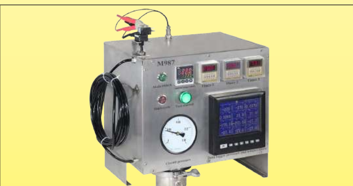
Apparecchiatura di test per misurare ripetutamente e costantemente la lunghezza massima dei tubi di collegamento degli interruttori pneumatici in funzione del volume del pulsante e della pressione che sviluppa (Laboratorio Ultimeat)
